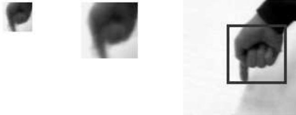
Abbildung 3: Matching eines Referenzmodells und einer Beobachtung: Die Referenz (links) wird skaliert (mitte) und die beste Position innerhalb der Beobachtung wird bestimmt (rechts).
